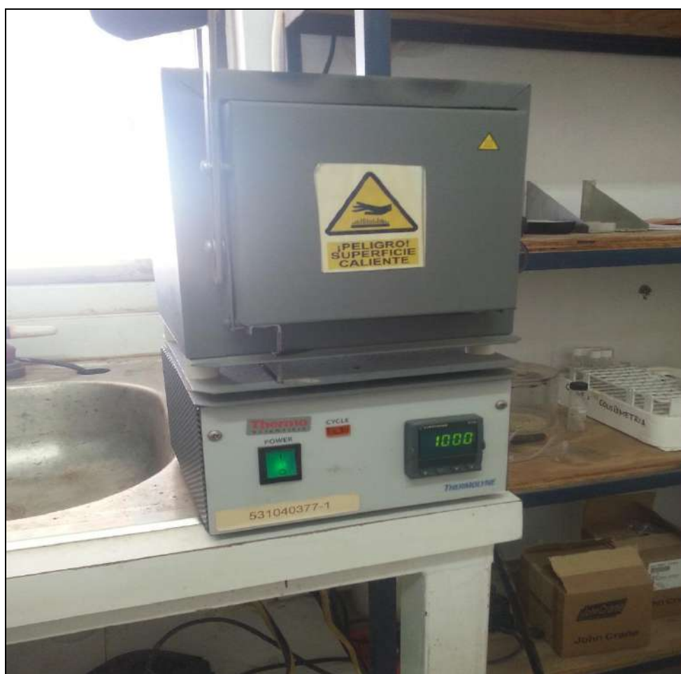
Figura 2. Mufla utilizada en la quema de muestras de paja de trigo
