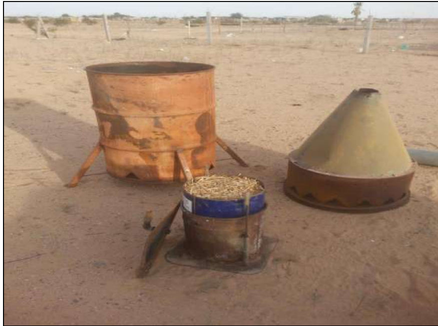
Figura 16. Mini reactor cargado de biomasa densificada de paja de trigo.
