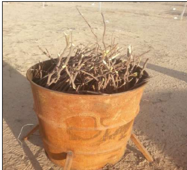
Figura 18. Horno artesano con mini reactor en interior y biomasa de mezquite.
