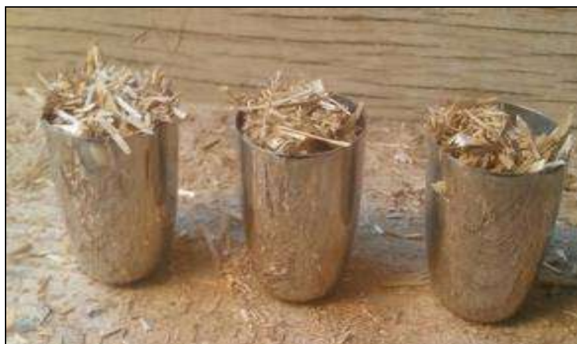
Figura 9. Crisoles cargados de biomasa densificada.
